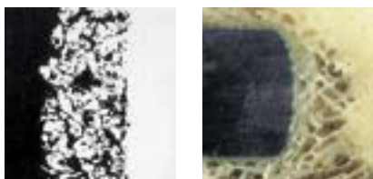
Поперечний зріз Plasmapore® і його контакт із кісткою
